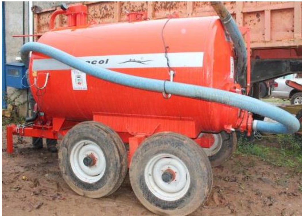
Figura 17 – Equipamento sugador para limpeza de fossas sépticas - Fonte: Acervo da prefeitura municipal,2015
